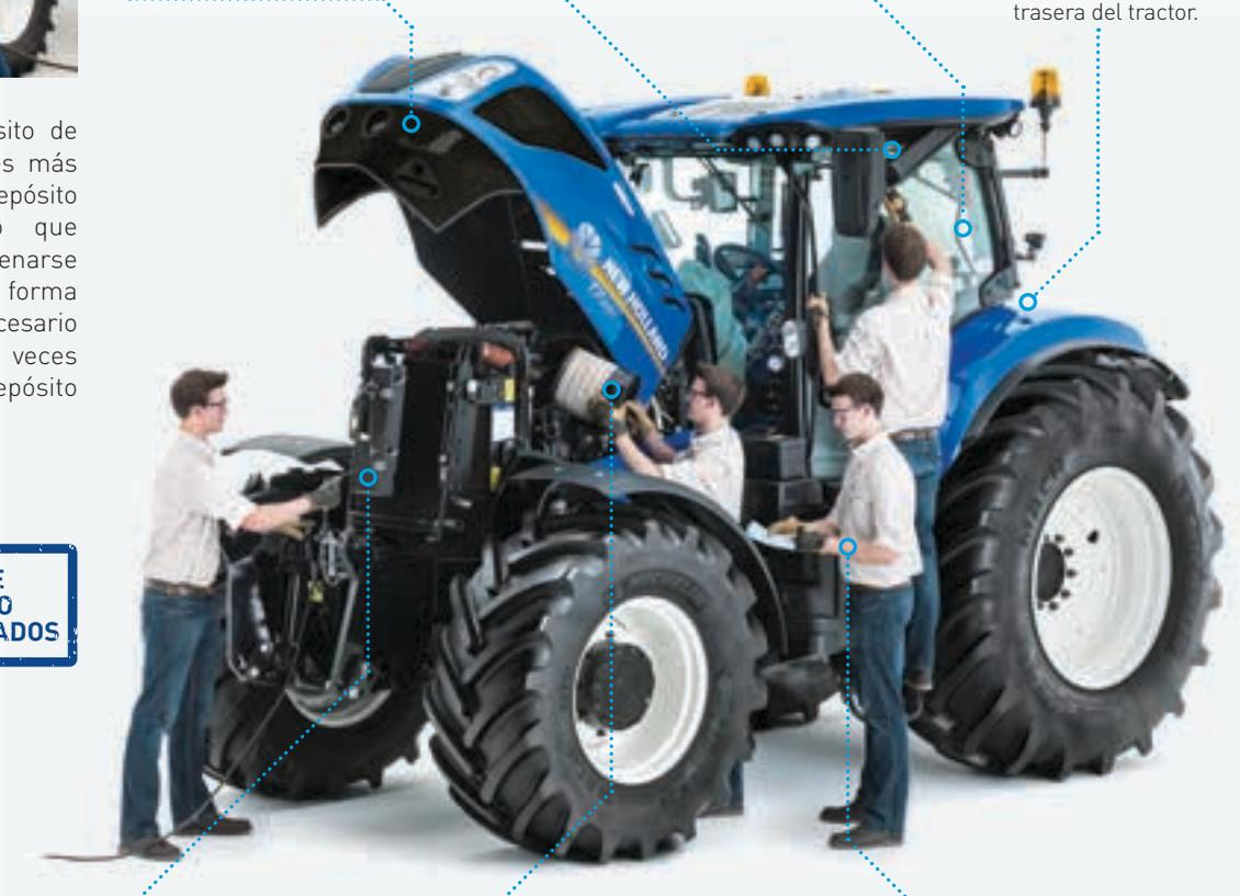
El sistema de refrigeración se abre para facilitar y agilizar la limpieza.
