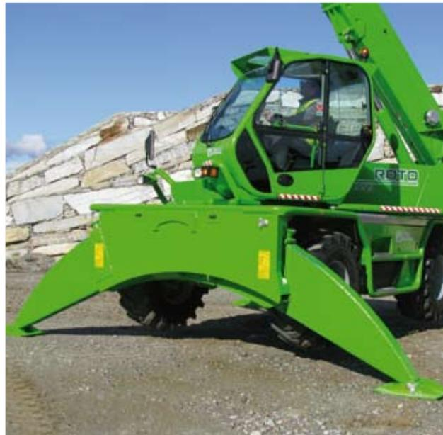
◀ **Estabilizadores con extensión y posicionamiento independiente** en los Roto de la serie MCSS. Para el empleo en áreas con reducida resistencia específica hay previstas unas placas adicionales de gran superficie que permiten aumentar la versatilidad.
