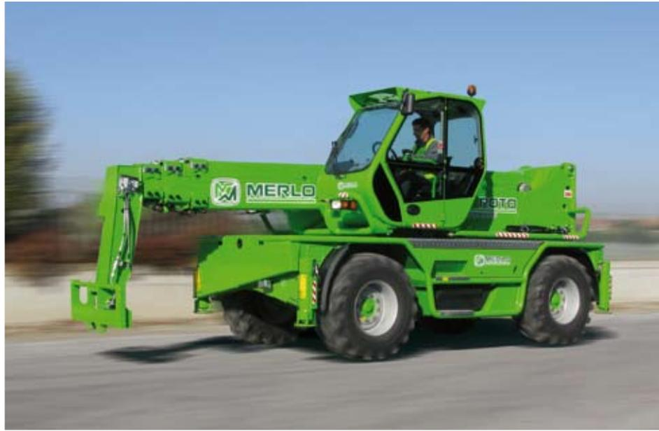
◀ Las suspensiones pueden bloquearse en la posición que se quiera para garantizar la **estabilidad necesaria y la seguridad** en las operaciones de elevación sobre neumáticos.
