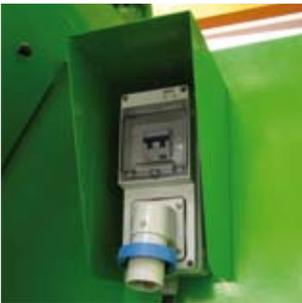
Una **toma de corriente** con **220 V** con interruptor diferencial y un conducto de aire o de agua con conexión rápida, que bajo pedido se pueden montar en la torreta, permiten alimentar los servicios eventuales en uso en la plataforma de trabajo aérea.
