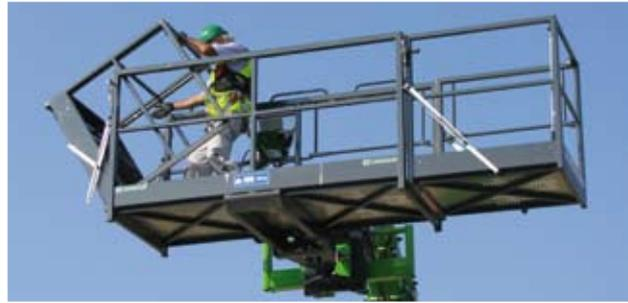
La **rotación hidráulica en torno al eje vertical** de numerosas plataformas Merlo permite trabajar incluso con la máquina angulada.
