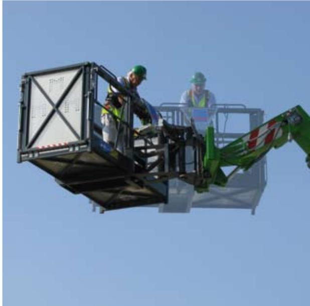
En algunas plataformas aéreas Merlo el ancho útil se puede variar gracias al **sistema de extensión patentado** que se puede utilizar también en altura.
