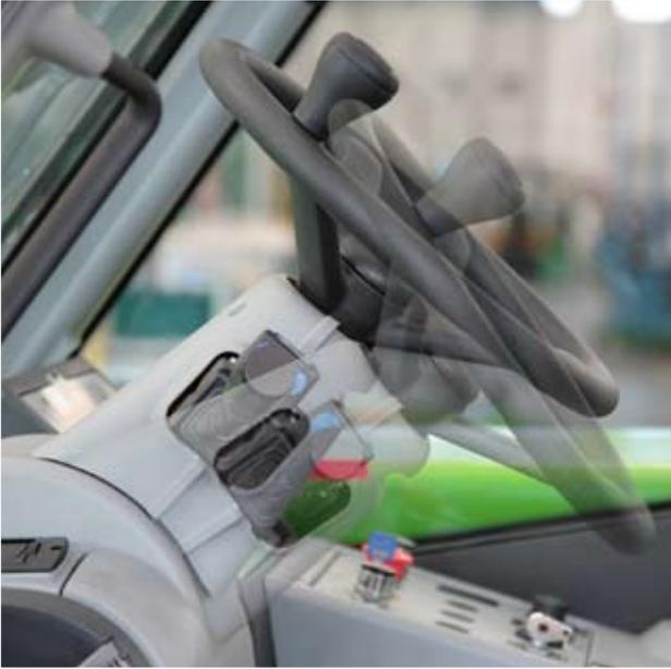
◀ **La inclinación del volante** admite una regulación de hasta 16 grados para adaptarse a las diferentes exigencias de conducción.
