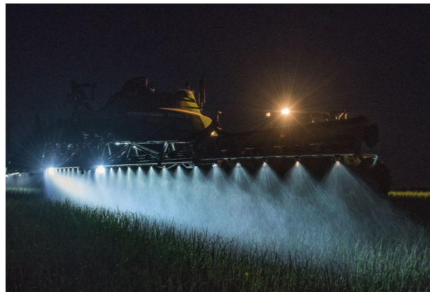
■ Éclairage LED, pour une visibilité optimale sur les buses. 2 ou 4 lampes LED bleues également disponibles en option. Les phares sont montés devant la buse, pour protéger contre les dépôts.
