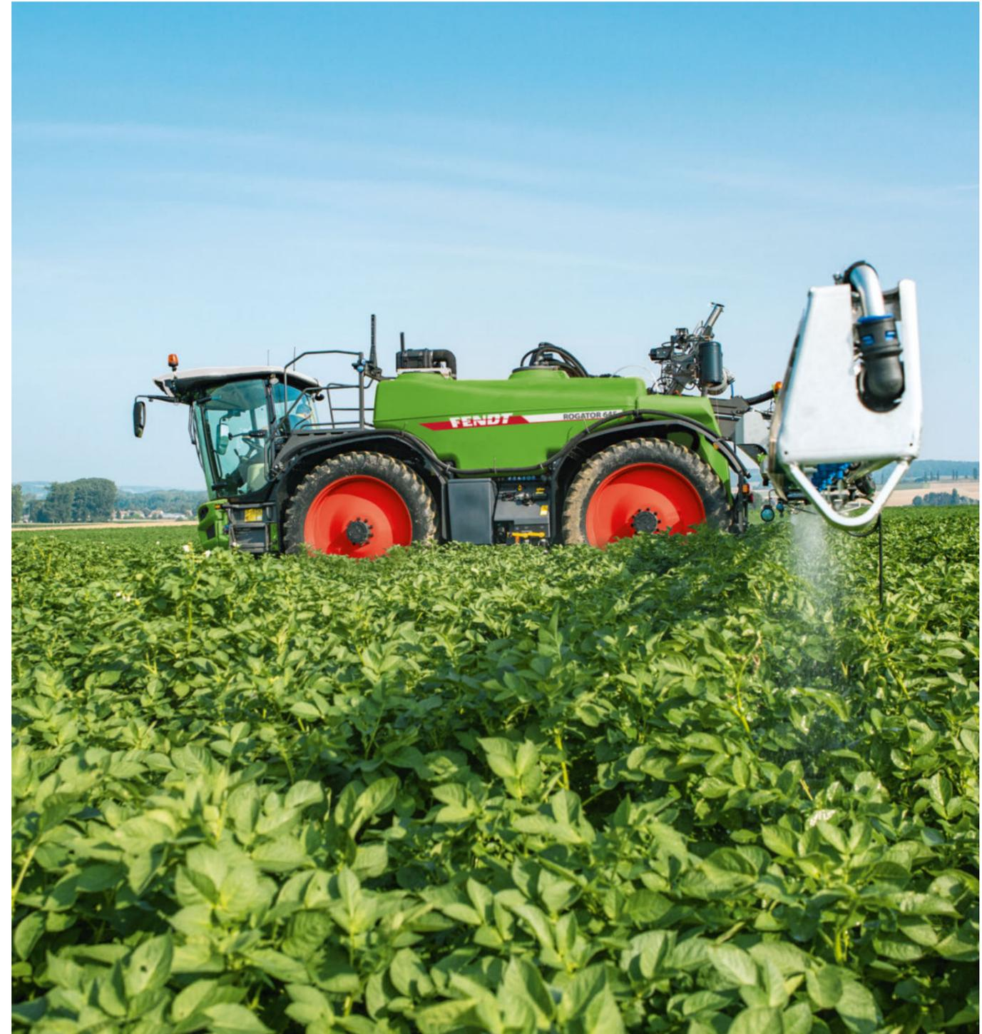
Con el caudal máximo de 785 l/min de la bomba, aplicar fertilizantes líquidos es un juego de niños. El accionamiento hidráulico de la bomba centrífuga utiliza toda la potencia hidráulica que necesita mediante el CDS. El Fendt Rogator siempre funciona a la velocidad más baja posible dentro del rango eficiente.
