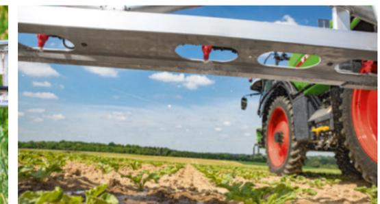
El protector antigolpes del Fendt Rogator puede girar hasta 90°. Amortigua la oscilación hacia atrás para que ningún impulso añadido afecte a la barra de pulverización.
