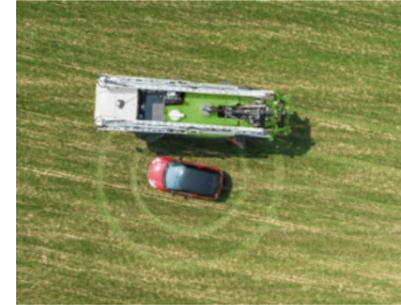
Agilidad sin rival: Gracias al sistema de dirección 4WD, las ruedas traseras siguen con exactitud las rodadas de las ruedas delanteras sin apenas dañar las plantas.
