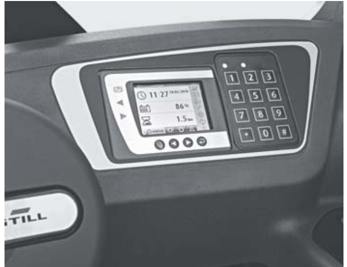
Immer alles im Blick: Display zeigt Batteriestand, Datum und Uhrzeit
