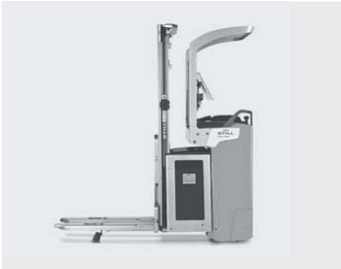
Hohe Umschlagleistung dank Horizontaltransport von Lasten bis zu 2.000 kg auf dem Initialhub
