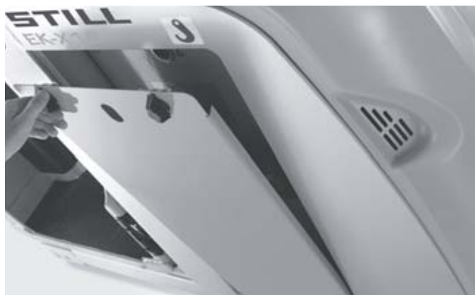
Le couvercle du compartiment de batterie s'ouvre et se ferme sans outil
