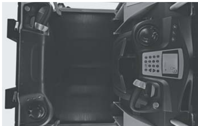
Utilisation optimale du chariot grâce à la commande côté moteur et également côté charge
