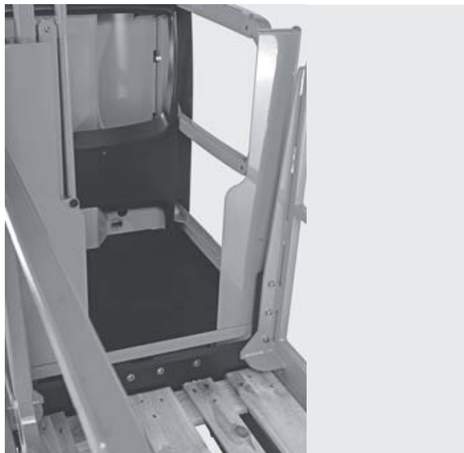
Possibilité d'accès simple et sécurisé à la palette via la barrière ouverte
