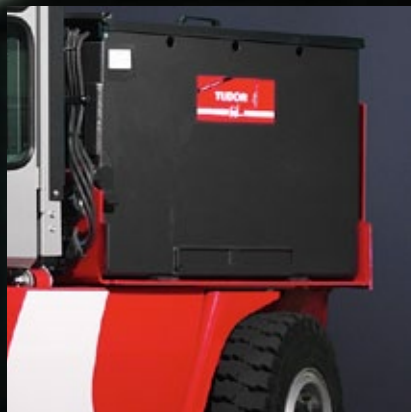
Das Batteriewechselsystem – abziehbar oder mit Gabeltaschen – erleichtert den Austausch der Batterie.
