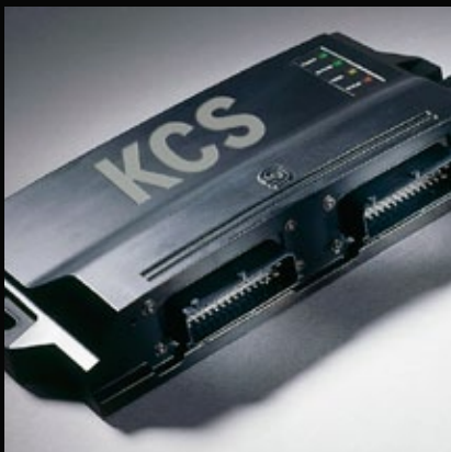
KCS – das von Kalmar entwickelte elektronische Steuerungssystem. CAN-bus-Technik und leistungsfähige Prozessoren garantieren hohe Produktivität und optimale Sicherheit.
