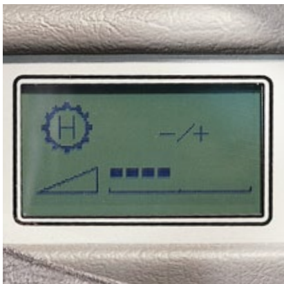
Die Motorbremse lässt sich in 9 verschiedene Stufen einstellen, von sanft bis kraftvoll.
