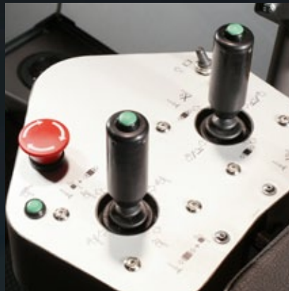
Spirit Delta und Spirit Delta Space. Optionen für mehr Komfort der Bedienfunktionen wie zum Beispiel ein Bedienhebel zur Steuerung der gesamten Hydraulik.
