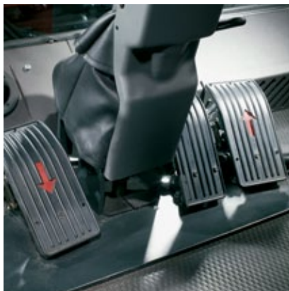
Durch die Anordnung der Pedalen für Vor- und Rückwärtsfahrt kann der Fahrer schnell und sicher manövrieren.
