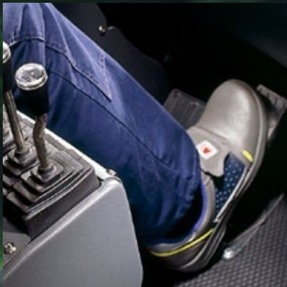
Optional: Inching, das über das KCS gesteuert wird. Dies ermöglicht ein genaues Fahren bei hoher Drehzahl und effizienter Hubleistung.
