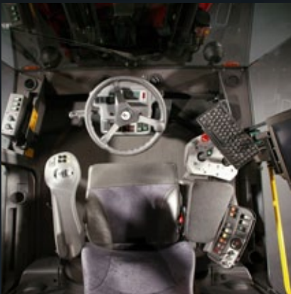
Die geräumige Spirit Delta Space. Hier „thront“ der Fahrer. Die Sicht auf die zu hebende Last, die Bedienelemente sowie die Rundumsicht sind optimal. Ausreichend Platz für Zusatzausrüstungen ist vorhanden.
