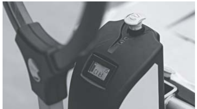
Immer alles im Blick: Multifunktionsdisplay zeigt Betriebsstunden, Hinweise, Ladezustand und optional Gewicht an
