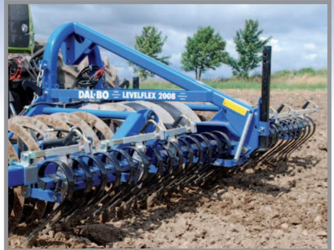
Die weit nach vorne reichende Frontaufhängung mit optimierter Lenkgeometrie "zieht" den Packer, so dass er sich im Feldeinsatz nahezu neutral am Schlepper verhält.
