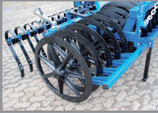
**Levelflex 2008** hat einen sehr robusten und formvollendet gestalteten Dreipunkturm. Die drei Anhängeshöhen für die Unterlenker und den Oberlenker gewährleisten den optimalen Anbau an alle Schleppergrößen. Die V-förmigen Stahlabstreifer arbeiten selbst unter schwierigen Bodenverhältnissen sehr effektiv und verhindern ein Einklemmen von Steinen.
