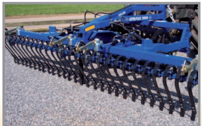
Für die optimale Rückverfestigung ausschließlich im Zwischenachsbereich empfehlen wir die Varianten mit 1,50 m Arbeitsbreite. Als besondere Neuheit gibt es hierfür ein 4,0 m hydraulisches Crackerboard, welches das Saatbett über die gesamte Arbeitsbreite krümelt und einebnet und nur den Bereich zwischen den Schlepperreifen verfestigt. Diese Variante ist sehr leichtzügig und eignet sich besonders für leichtere Böden mit schüttender Pflugfurche.
