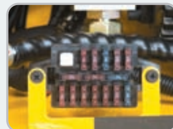
Boîte à fusibles concentrée pour inspection aisée
