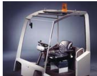
Offener Überrollbügel, der auch nach Auslieferung mit Fenstern und Türen vervollständigt werden kann.
