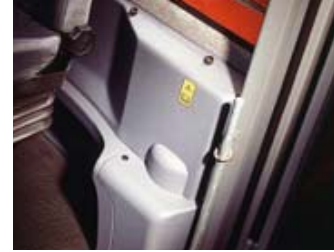
Der Elektroschrank ist leicht erreichbar und dennoch gut geschützt.
