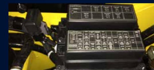
Tutti i fusibili e i relè sono centralizzati in tre basette con **protezione aumentata contro l'ingresso di polvere e acqua ai sensi di IP65**. Le basette sono ubicate sotto il pannello a pedana in una posizione **accessibile rapidamente**.
