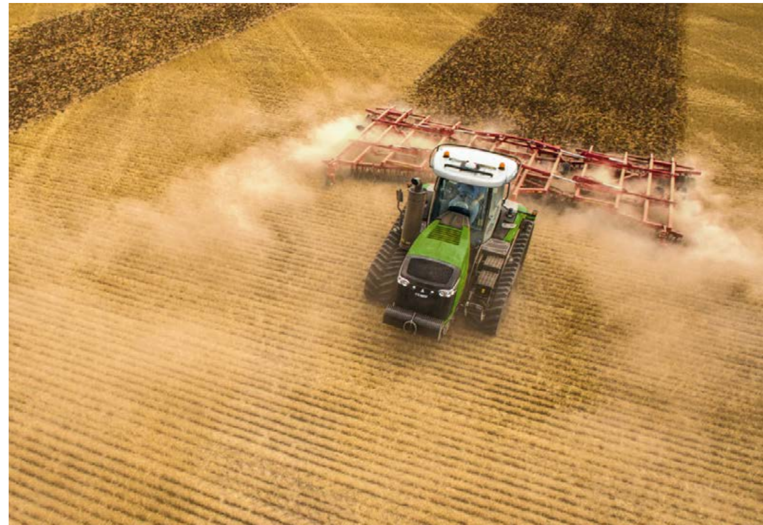
Belka zaczepowa sterowana hydraulicznie z zakresem wychylenia 28° w obie strony idealnie steruje narzędziami.
