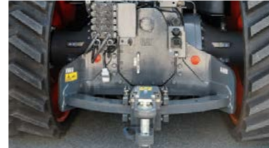
Belka zaczepowa sterowana hydraulicznie z zakresem wychylenia 28° w obie strony idealnie steruje narzędziami.
