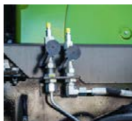
■ Al fine di regolare la tensione dei cingoli, i raccordi idraulici sono di facile accesso.
