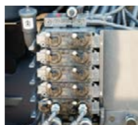
■ Sei distributori idraulici, un collegamento della linea di recupero olio e PowerBeyond sono posizionati sul retro.
