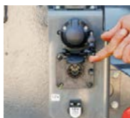
□ Una presa a 12 V è disponibile sul retro per le utenze esterne. Il connettore ISOBUS assicura il collegamento con le attrezzature.
