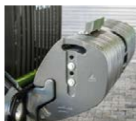
■ Un peso di 990 kg può essere montato sul telaio anteriore.
