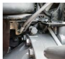
■ Il motore è installato in modo da essere ammortizzato.
