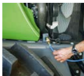
□ Un raccordo dell'aria compressa è posizionato anteriormente per pulire il radiatore.
