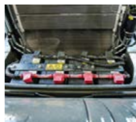
□ Quattro batterie esenti da manutenzione forniscono l'alimentazione su Fendt 1100 MT.
