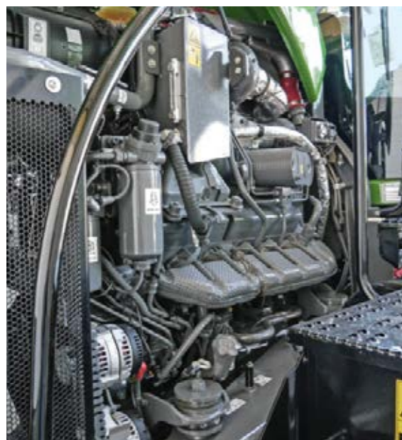
■ Il motore AGCO Power a 12 cilindri vi convincerà grazie al suo funzionamento regolare e all'agevole accesso di manutenzione.
