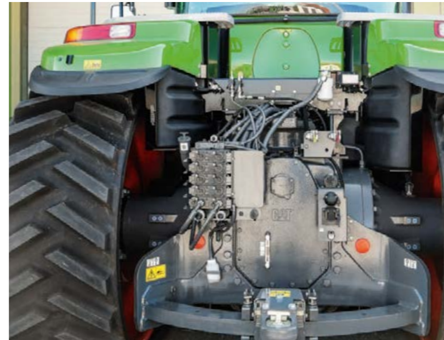
La barra di traino, con raggio di sterzata di 28° per ciascun lato, controlla perfettamente le attrezzature.
